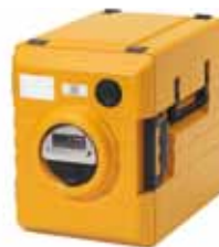
thermoport® 4.0 1000 KB zuheizbar Digitale Umluftheizung. Frontlader für max. 2 x GN 1/1 200 mm. Temperaturbereich: 85 °C. Inhalt: Max. 52 Liter Anschluss: 230 V; 0,8 kW Maße B/T/H: 435 x 688 x 561 mm
